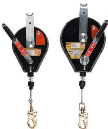
**Anticaídas autorretráctil con mecanismo de rescate/recuperación bidireccional. Anticaídas con dispositivo de elevación y bajada de rescate, equipado con un mecanismo de recuperación accionado por una manivela montada en el dispositivo. Tras detener una caída, o si el usuario queda incapacitado en la parte inferior de un eje, un segundo puede accionar el mecanismo de recuperación fácilmente para elevar o bajar a la persona a un lugar seguro.**
