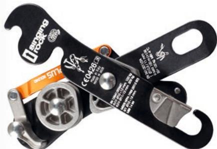
**Descensor manual con doble sistema autofrenante, que se bloquea tanto si se libera la palanca como si se presiona.**
