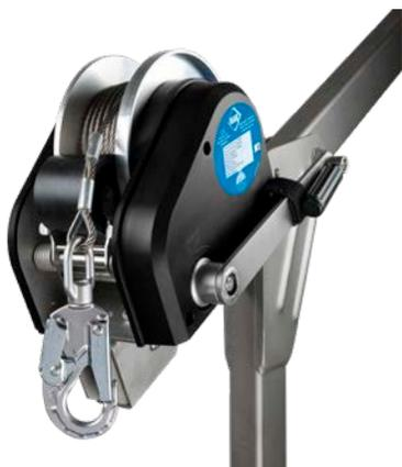
Cabrestante de manivela para levantar y bajar personas suavemente, bajo la norma 2006/42/EG, con 30 m de cable de acero inoxidable de  $\varnothing$  6 mm (carga de rotura mínima 18,76 kN). La capacidad de carga es de 300 kg.
